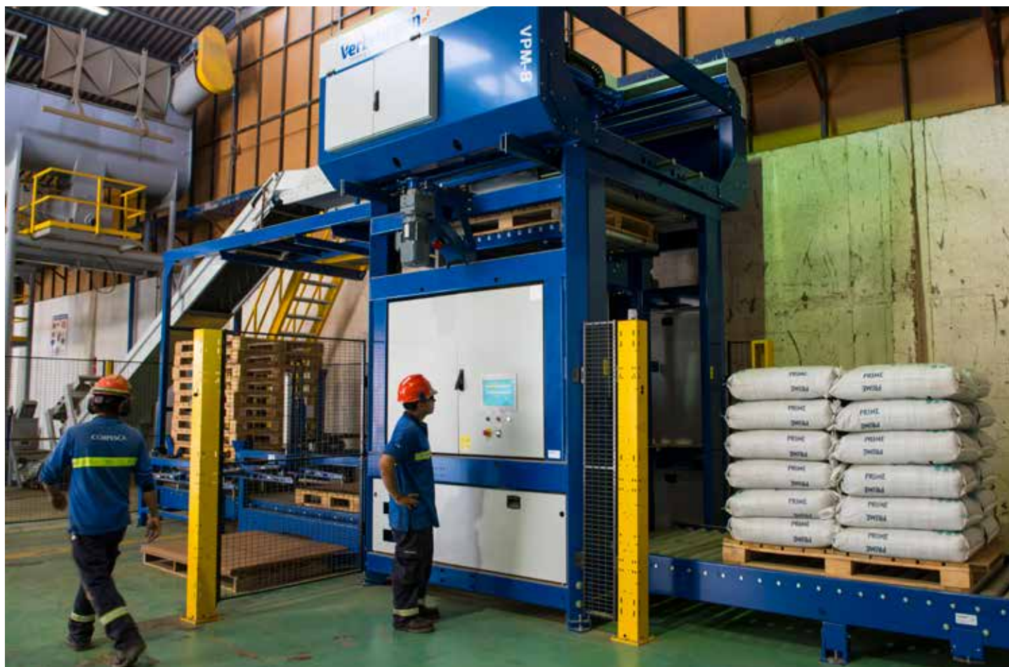
Paletizadora en zona de transformación de harina de pescado, planta de Iquique, Corpesca S.A.
